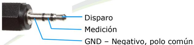
Imagen 22: Conexiones del terminal de la cámara
