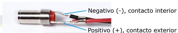
Imagen 23: Conexiones de la clavija DC
