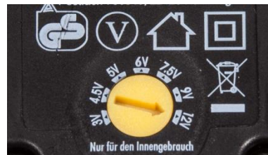
Figure 6: Sélecteur de tension réglé sur 12 V
