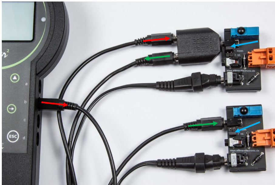
Figure 15: Deux distributeurs de gouttes connectés à une sortie du Joker²
